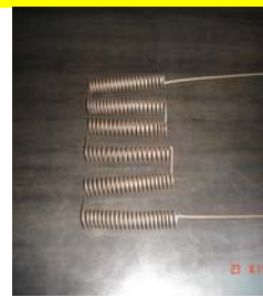
ตัด Heater wire
